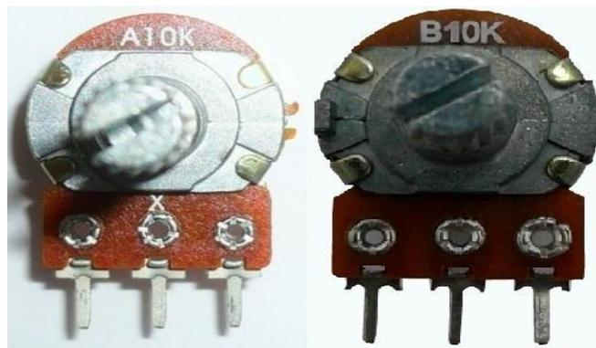
Figura 10 - Potenciômetro A10K e B10K
